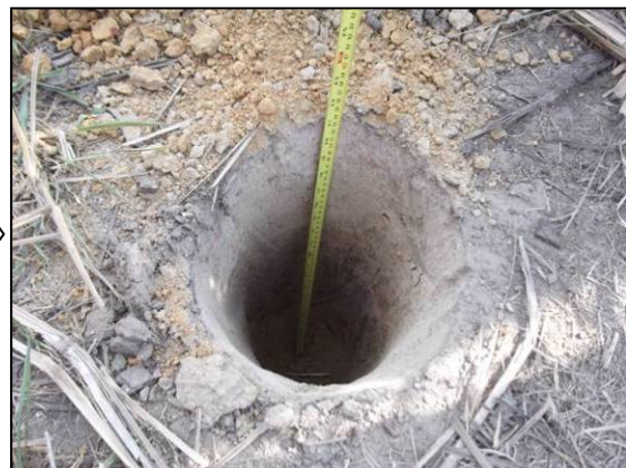
Perfuração paralisada devido ao alto índice de cascalho junto ao sedimento de coloração marrom. (Topo).
